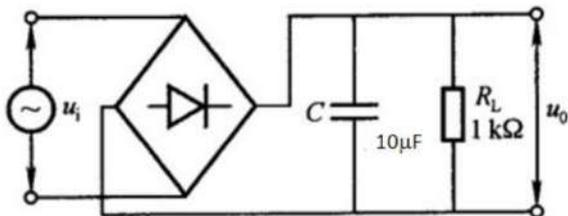
图 1.3 全波整流单电容滤波电路
