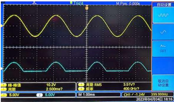
图 2.1 初始信号、半波整流波形
