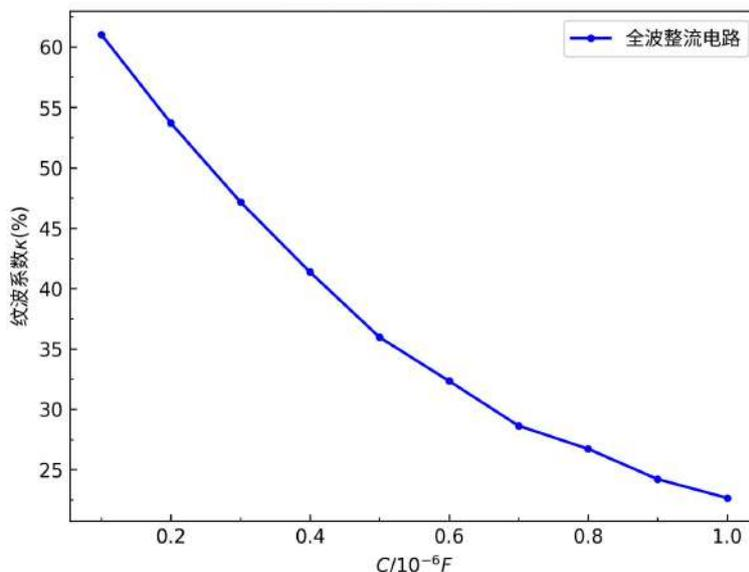
图 3.2 单电容滤波的纹波系数-电容曲线
