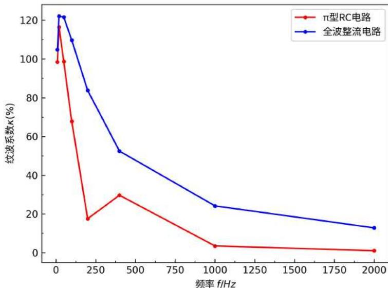
图 3.1 单电容滤波、π 型 RC 滤波的纹波系数-频率曲线
