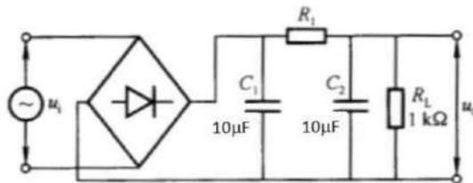
图 1.4  $\pi$  型 RC 滤波电路
